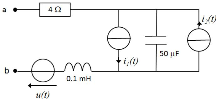
Considérez le circuit ci-dessus. Nous avons  $u(t) = 4 \cos(20000t + 90^\circ)$  V,  $i_1(t) = 10 \cos(20000t)$  A, et  $i_2(t) = 6 \cos(20000t)$  A. Nous cherchons l'équivalent de Norton de ce circuit vu des bornes a et b.
