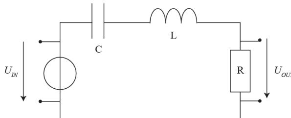
Considérez le circuit ci-contre, un filtre passe bande  $RLC$  série. Le condensateur a une capacité de  $1 \mu\text{F}$ . Nous devons choisir les valeurs de  $R$  et de  $L$  pour que ce filtre puisse sélectionner les fréquences comprises entre les deux fréquences de coupure de  $1 \text{ kHz}$  et  $10 \text{ kHz}$ . Nous avons étudié ce filtre en classe et allons maintenant voir 2 autres méthodes.
